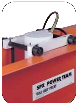
El cilindro se mueve con facilidad por toda la anchura del travesaño superior.
