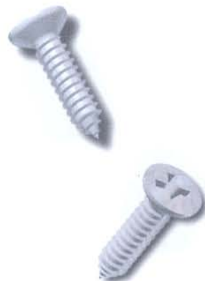
Tornillo avellanado para chapa con huella Ph2 Ø7.25 mm y longitud de caña de 16 mm. para roscar en plástico.
