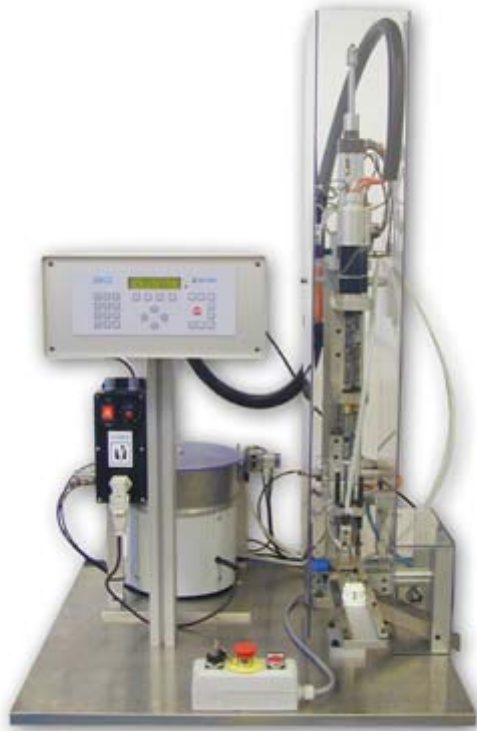
Atornillador de 2 husos automático para enchufes eléctricos con descarga automática de estos, alimentador de tornillos de plástico y controlador SBC2
