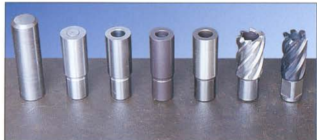
Pasos de trabajo en la fabricación de brocas huecas
